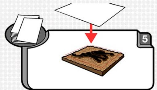
6- On utilise une presse à cylindres pour la gravure : Le plateau se déplace horizontalement entre 2 cylindres qui vont comprimer le papier contre la plaque encrée. On renouvelle l'opération pour chaque tirage.
